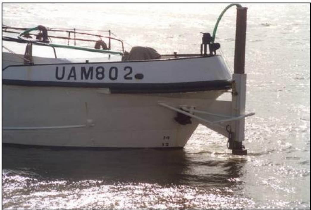
Fig. 3.19 « Sondeur hors-bord d'étrave »
