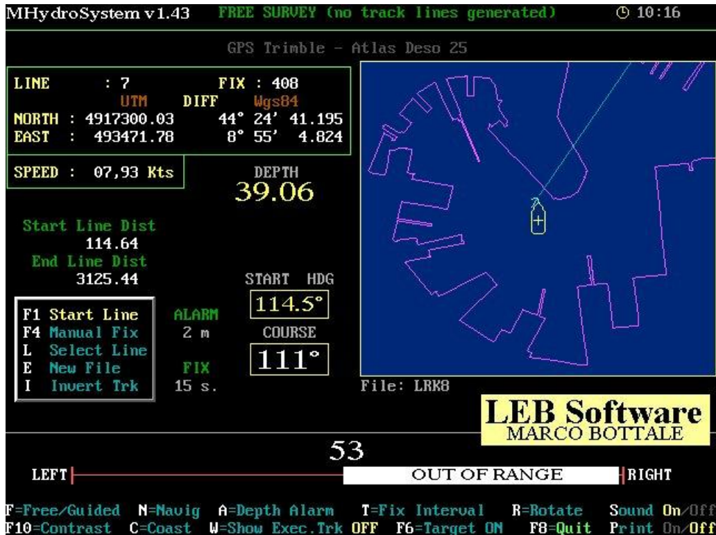
Fig. 7.15 « Copie d'écran d'un système d'acquisition automatique »
